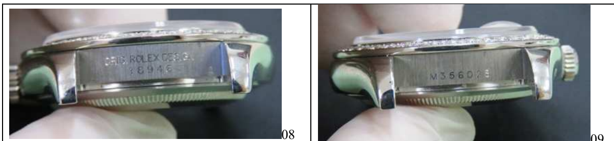
Figuras 08 e 09 – Número do modelo (18946) e de fabricação (M356028) constantes nos encaixes da pulseira com a caixa
