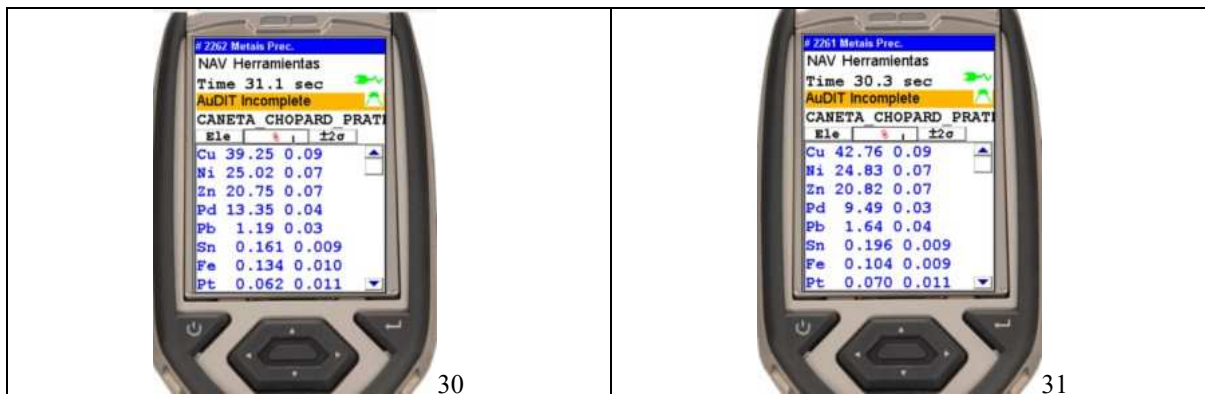
Exames realizados na liga metálica da caneta (corpo e ponteira) indicam tratar-se de liga metálica banhada em paládio (fig. 30 e 31)
